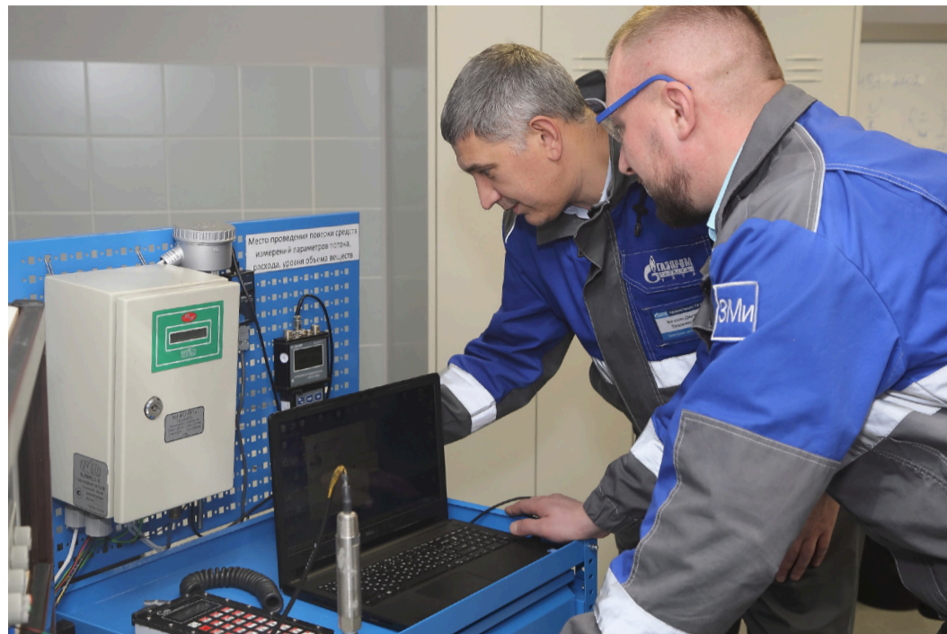
Поверка комплекса многоиточного измерительного микропроцессора «Суперфлоу-2Е». Сотрудники отдела поверки и калибровки: заместитель начальника Дмитрий Владимирович Васенин и инженер Роман Михайлович Тыркасов.
