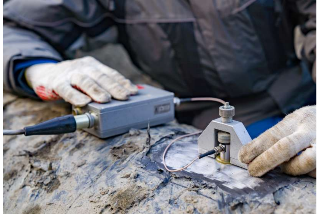
Акустико-эмиссионный контроль фиксирует акустические волны ультразвукового диапазона, возникающие в процессе деформаций в трубопроводах
