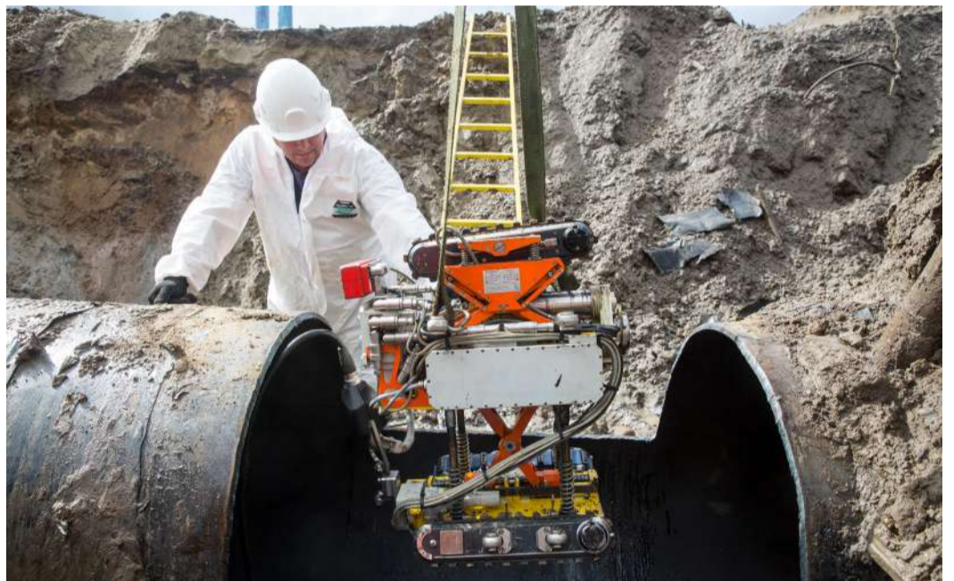
Слесарь отдела внутритрубной диагностики и ремонта Дмитрий Владимирович Оберемко проводит испытания взрывозащищенного средства доставки модулей визуально-измерительного и ультразвукового контроля
