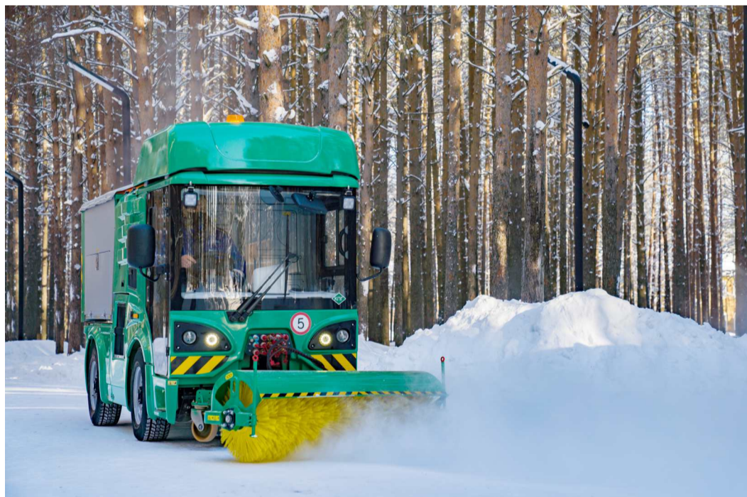
Машина коммунальная (вакуумная-подметальная) МК 2000, изготовитель ПАО «МЗИК», г. Екатеринбург
