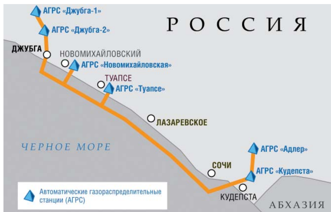
На расстоянии около 4 километров от берега пролегает газопровод «Джубга — Лазаревское — Сочи».
