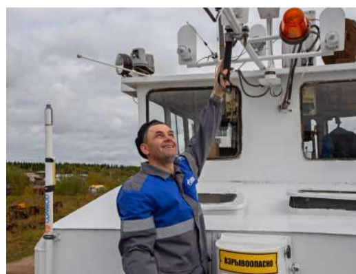
Осмотр ходовых огней и соединения антенн радиостанции
