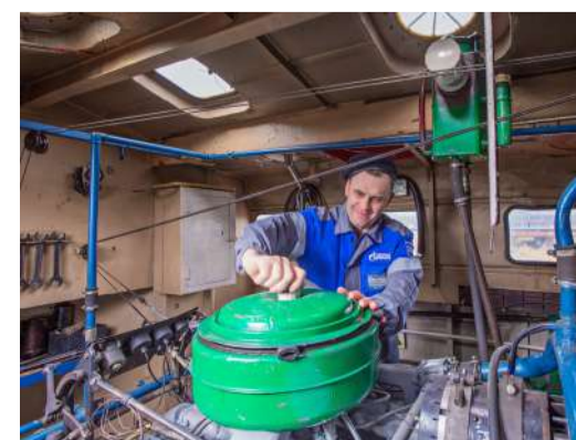
Промывка и очистка воздушного фильтра
