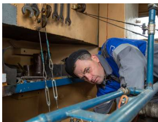
Затяжка гаек на полумуфте гребного вала
