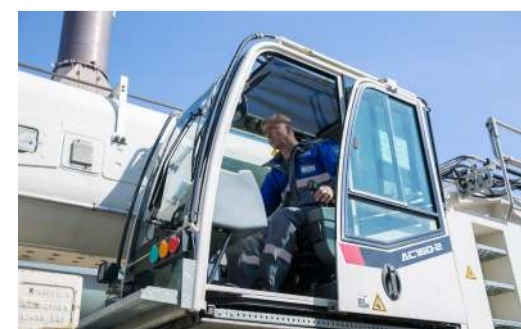
Кабина машиниста автокрана находится на высоте 1,8 м
