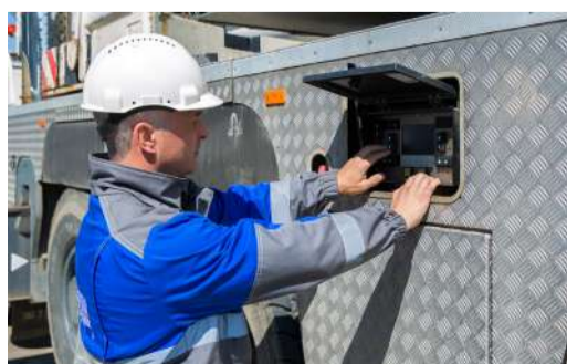
Пульт управления выносными опорами автокрана
