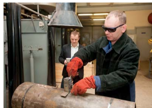
Евгений Погорелов, Юбилейное ЛПУМГ. Задание по термитной приварке
