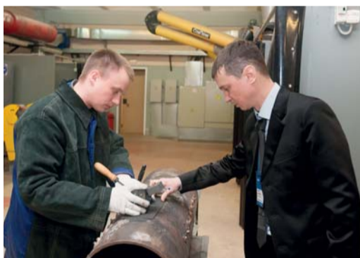
Пётр Сернов, Нюксенское ЛПУМГ, и Денис Редькин, ИТЦ. Задание по термитной приварке
