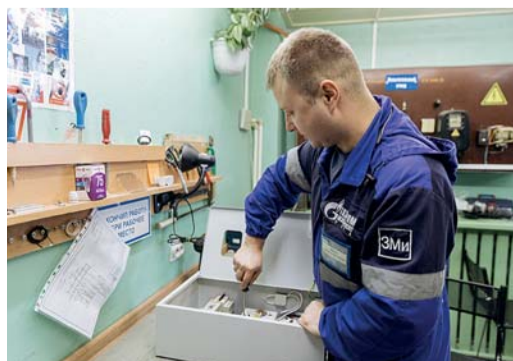
Электромонтёр Андрей Лобанов собирает щит учёта электроэнергии
