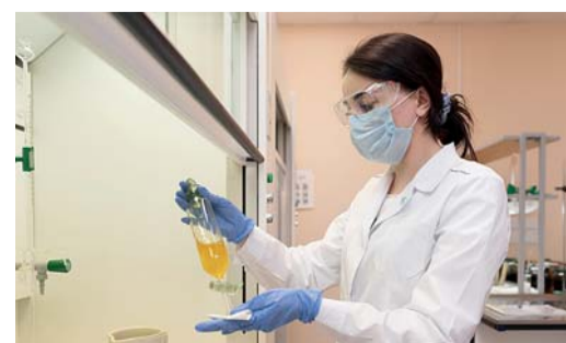
Елена Врублевская, лаборант химического анализа, производит определение наличия водорастворимых кислот и щелочей
