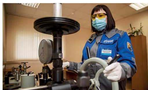
Екатерина Габделова, приборист группы метрологического обеспечения технологического процесса, производит калибровку технического манометра
