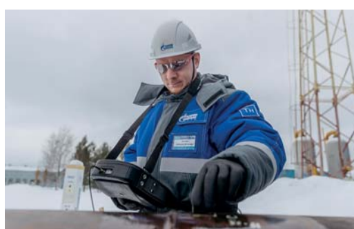
Ультразвуковой контроль сварного соединения
