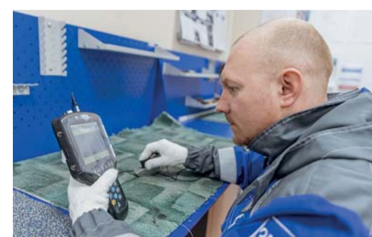
Настройка ультразвукового дефектоскопа
