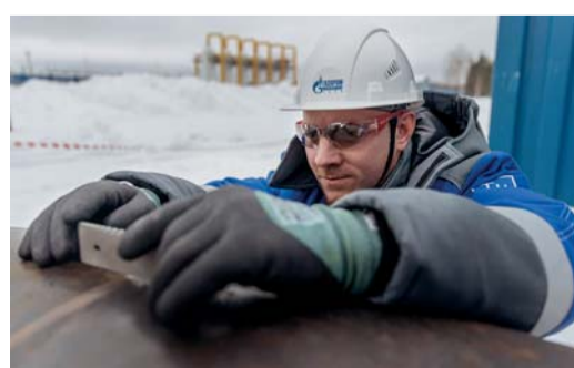
Определение величины смещения кромок сварного соединения
