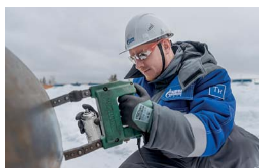
Магнитно-порошковый контроль основного металла трубы
