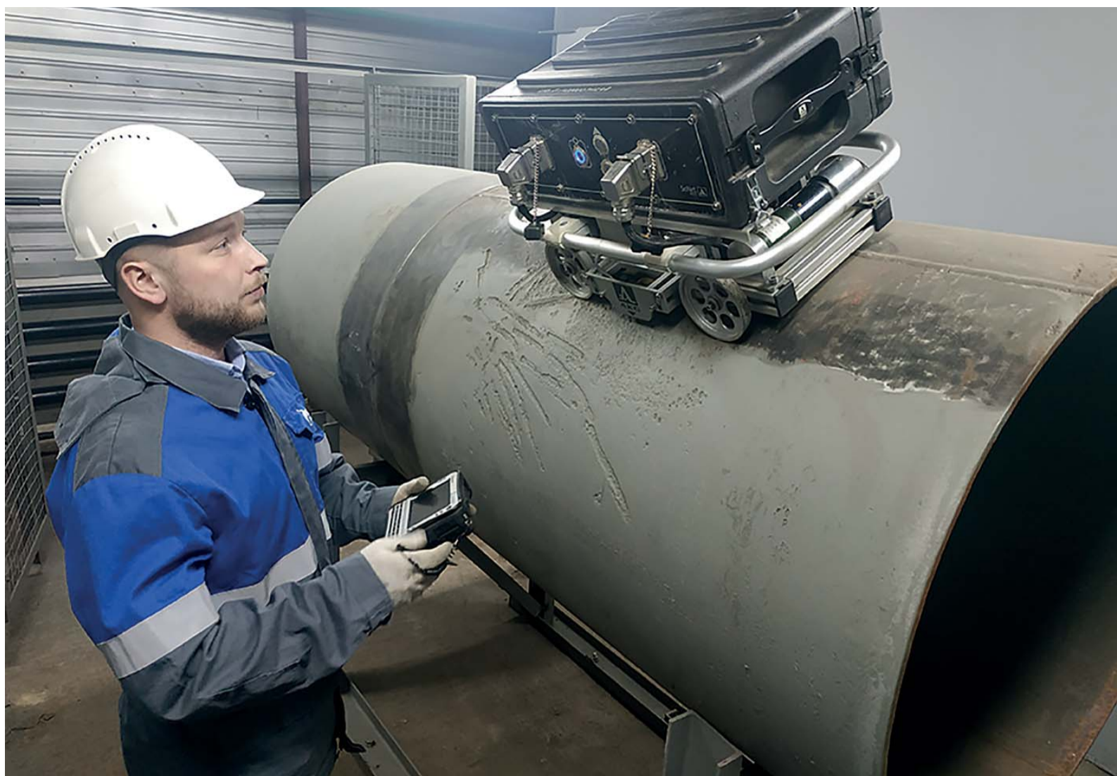
Вячеслав Ожегов, инженер 2 категории отдела неразрушающего контроля Инженерно-технического центра, проводит настройку-калибровку прибора A2075 SoNet
