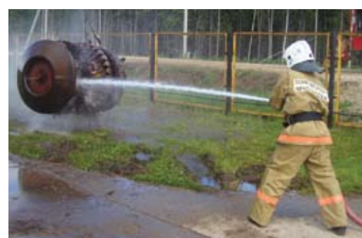
Очистка профилемера после извлечения его из камеры.
