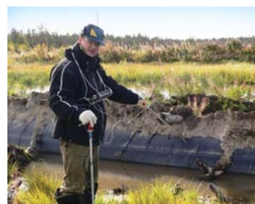
Поиск дефектов изоляции прибором ИПИ
