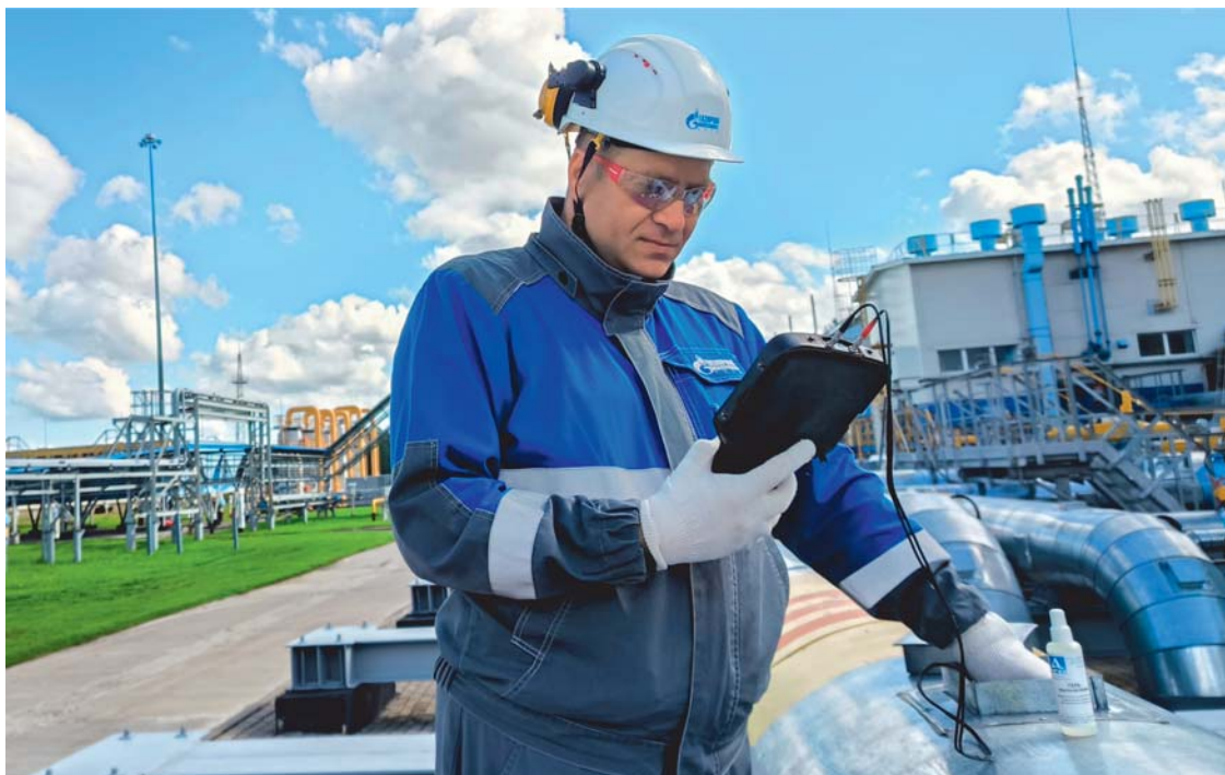
Станислав Владимирович Синчуринов проводит диагностику технологических трубопроводов газоперекачивающего агрегата № 38 компрессорного цеха № 3 «Бис»
