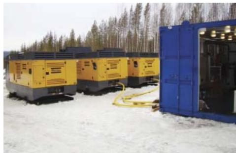
Три компрессора, один из них резервный, и азотная установка.
