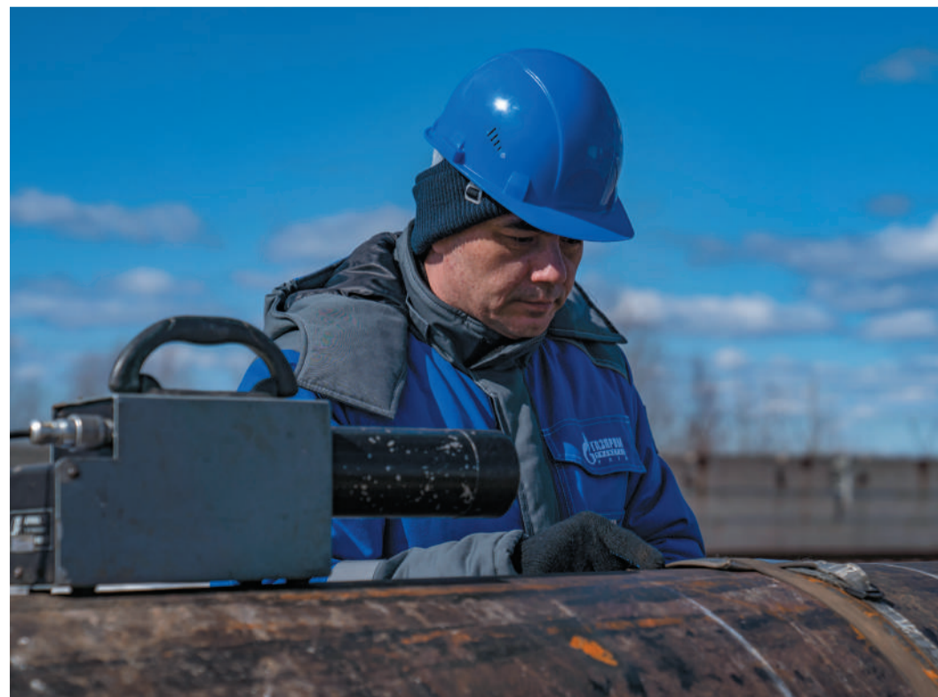
Максим Николаевич Петрыкин выполняет укладку рентгенографических кассет на сварное соединение
